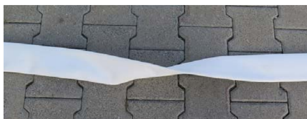
Halbe Schlauchverdrehung -> keine Fehlerpunkte
