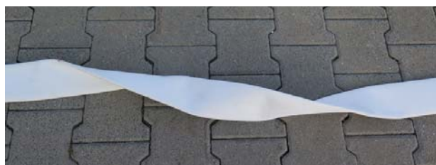
Ganze Schlauchverdrehung -> Fehlerpunkte
