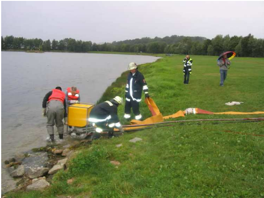
Schwimmfähige Kreislumpumpe wird zu Wasser gelassen
