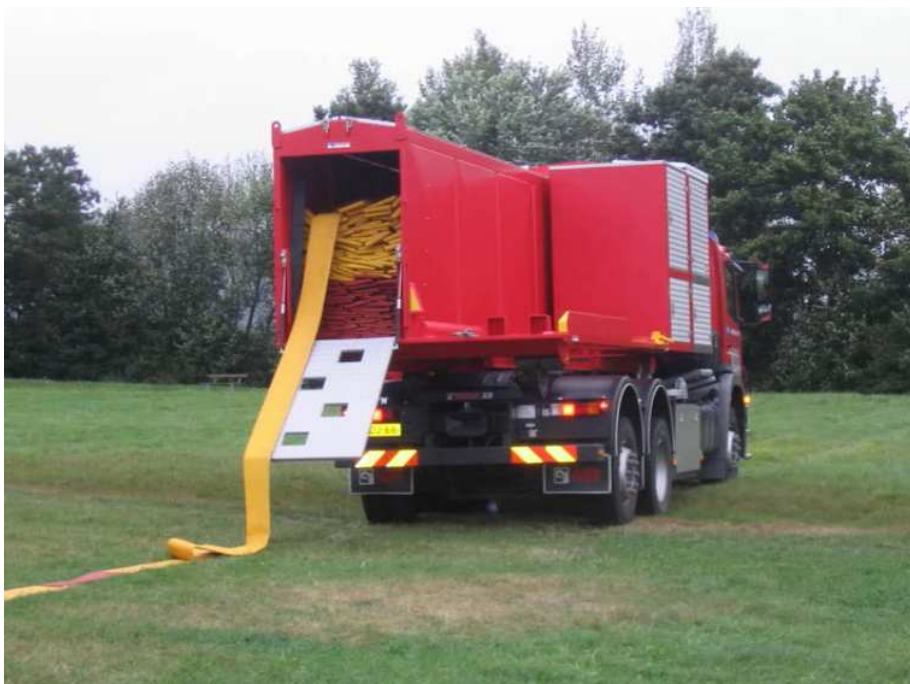
Verlegung der F-Schläuche
